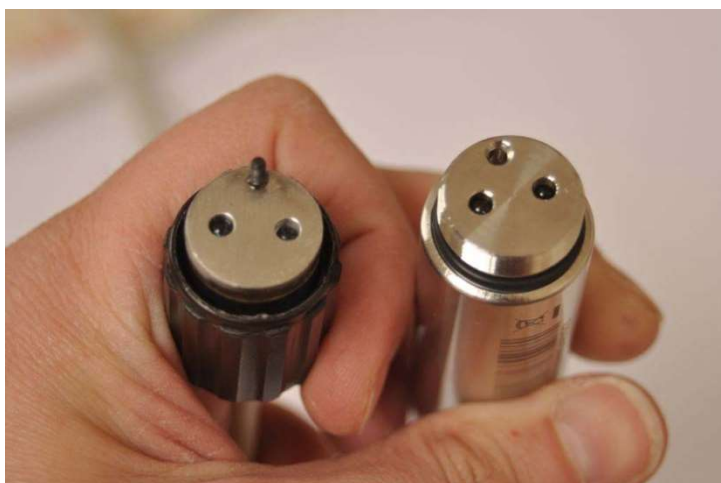
Obr. 11: Propojení senzoru s konektorem kabelu.
