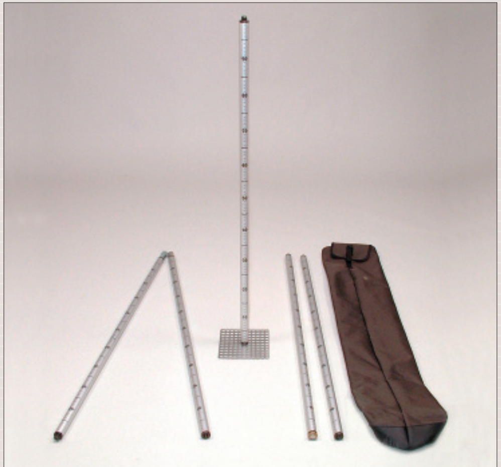
Sediment level stave set
