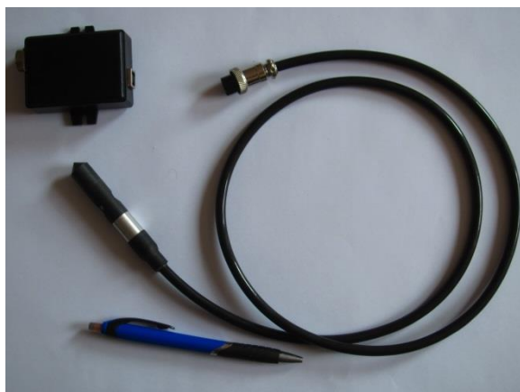
Obrázek: Sonda pro přímé měření
