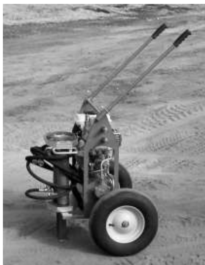
Hydraulické vytahovací zařízení 14 t (Benzin) transportní poloha
