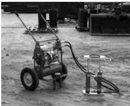
Hydraulické vytahovací zařízení 14 t (Benzin) pracovní poloha
