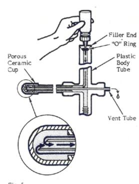
Fig. 5 (Fig. 5) Filling the Soilmoisture Probe
