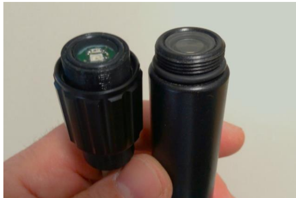
Obr. 10: Konektory senzorů Solinst (vlevo starší typ, vpravo novější)
