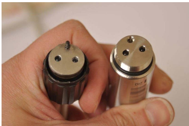
Obr. 10: Konektory senzorů Solinst (vlevo starší typ, vpravo novější)
