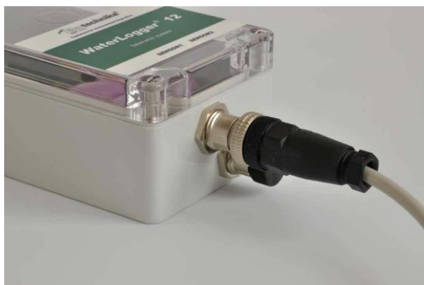
Obr. 8: Konektory senzorů s připojeným senzorem Solinst
