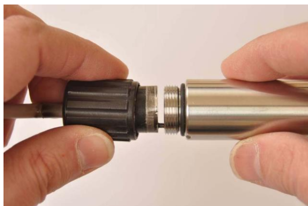
Obr. 12: Správná orientace konektoru před zašroubováním
