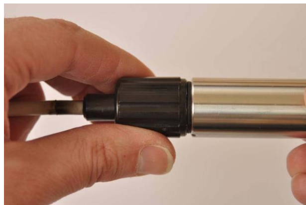
Obr. 12: Konektor po zašroubování
