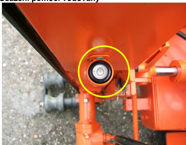
Usazení pomocí vodováhy
