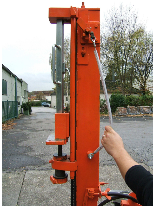
Jištění vodících saní uvolněno
